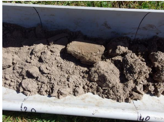
Exemple du sondage 1 avec taches apparaissant entre 0,2 et 0,4m, - 09/2021
