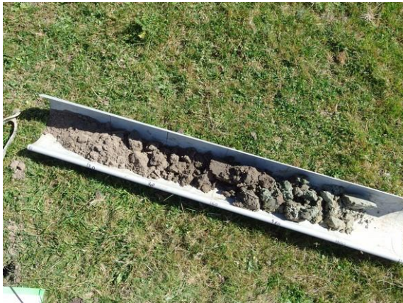
Exemple du sondage 1 avec taches apparaissant entre 0,2 et 0,4m, - 09/2021
